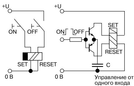
Рис. 5. Схемы управления бистабильным реле с двумя катушками [3]
