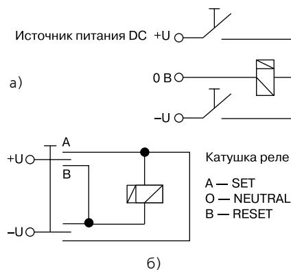
Рис. 4. Схемы управления бистабильным реле с одной катушкой [3]:
